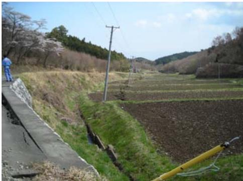
塩ノ平の断層露頭の北方延長の水田に、断層変位が延長する。写真は北方から撮影。西側（写真の右側）が約 70cm 低下。
