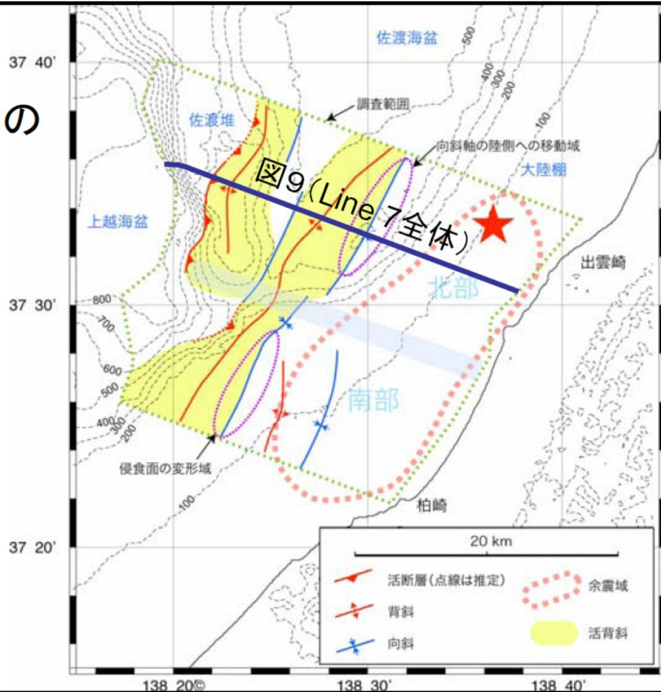
Line 7の褶曲構造から推定される断層の模式図
