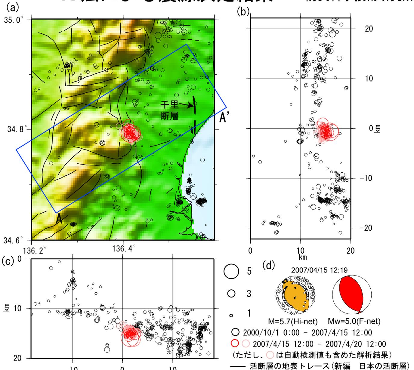
図1 防災科研Hi-netによる三重県中部の震源をDD法により再決定した震源分布を示す。(a)震央分布(深さ0~20km)、(b)南北断面に投影した震源深さ分布、(c)東西断面に投影した震源深さ分布、(d)本震の初動メカニズム解およびMT解。
