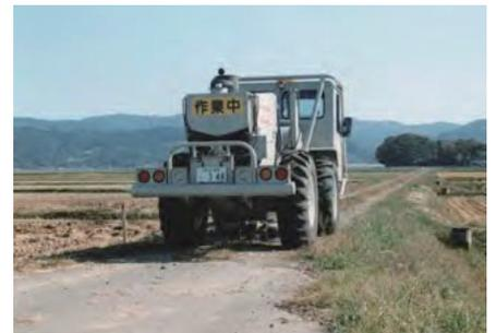
人工的に地面を揺らして、地下の構造を調査（山形県） 写真提供：山形県
