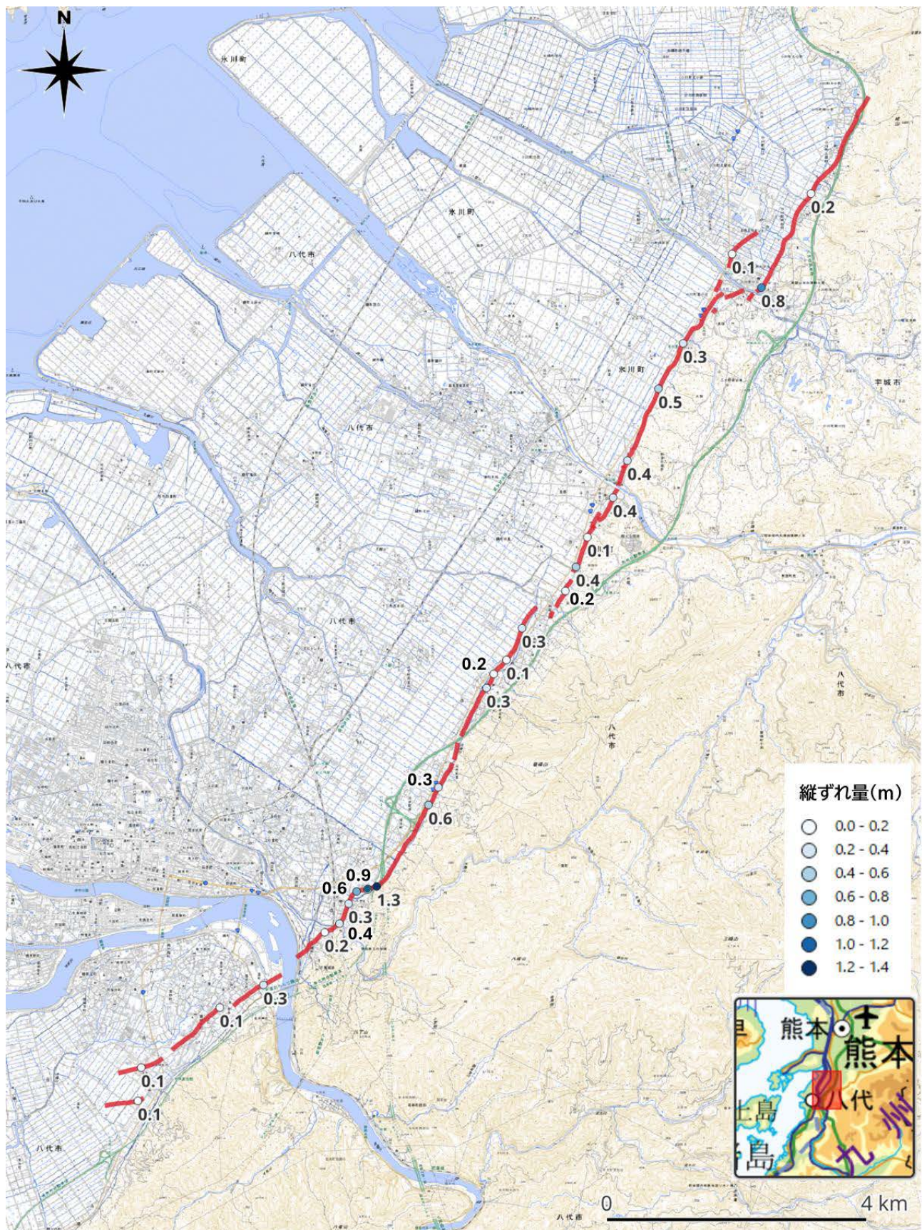
図4 変位境界における縦ずれ量(八代平野)
