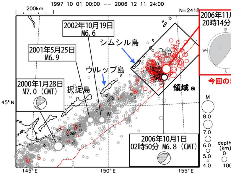
[今回の地震の発震機構解はハーバード大学による CMT 解。今回の地震活動の震源は、気象庁が震源を精度良く決定できる領域から離れているため、一部精度の良くないものも含まれている]
