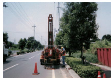
人工的に地面を揺らして、地下の構造を調査（埼玉県） 写真提供：埼玉県
